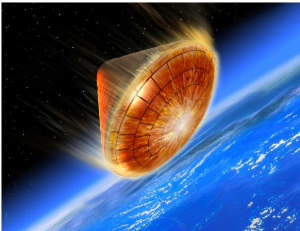
Fig. 5.5: Die Apollo - Raumkapseln mussten beim Wiedereintauchen in die Erdatmosphäre mit über 10 km/s Geschwindigkeit einen sehr flachen Eintauchwinkel einhalten, der in 100 km Höhe nur etwa 5.5 bis 6.5 Grad Neigung zur Erdoberfläche hatte. (Bildquelle: NASA)
