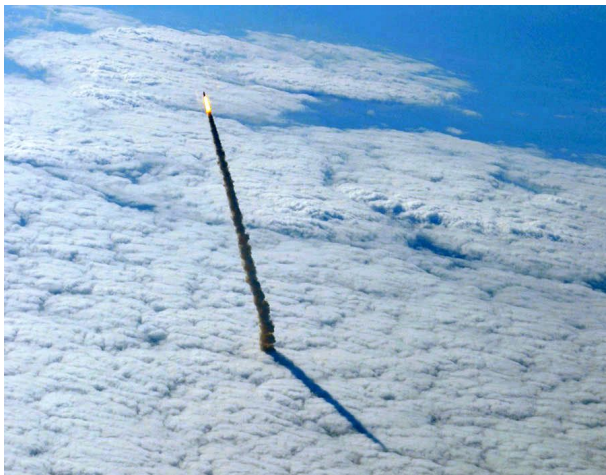
Fig. 6.8: Die Aufstiegsbahn einer Rakete (Space Shuttle) ist eine genau vorgegebene Flugbahn, die durch Schwenkung der Triebwerke ( gimbaled thrust ) genau verfolgt wird.
