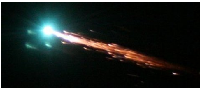
Fig. 5.14: Der kontrollierte Absturz des 14 Tonnen schweren ATV-002 Frachters „Johannes Kepler“ von der Internationalen Raumstation im Juni 2011. Da einige Details des Verglühens in der Erdatmosphäre bis heute nicht gut verstanden sind, hatte er einen „Reentry Break-up Recorder“ an Bord. In etwa 80 km Flughöhe brach allerdings der Kontakt ab. (Bild: ESA)
