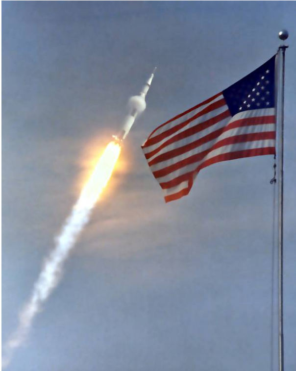
Fig. 6.4: Start der Saturn V (Apollo 11) im Jahre 1969. Wenn die Schallgeschwindigkeit überschritten ist, tritt am Flugkörper ein eigenartiges Phänomen auf, die sogenannte Prandtl-Glauert-Kondensationswolke . Es handelt sich hier um kondensierte Wassertropfen hinter der Überschall - Schockwelle.
